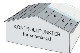
Pomiar ilości śniegu w różnych punktach kontrolnych na dachu.
