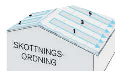
Kolejność odśnieżania dla uniknięcia nierównomiernego obciążenia dachu.
